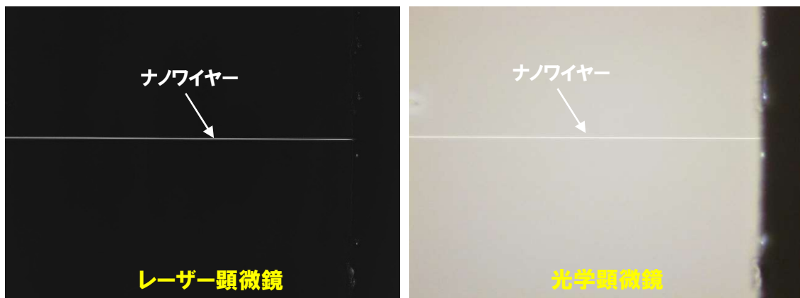
(a) ビスマスナノワイヤー端部(断線箇所なし)
