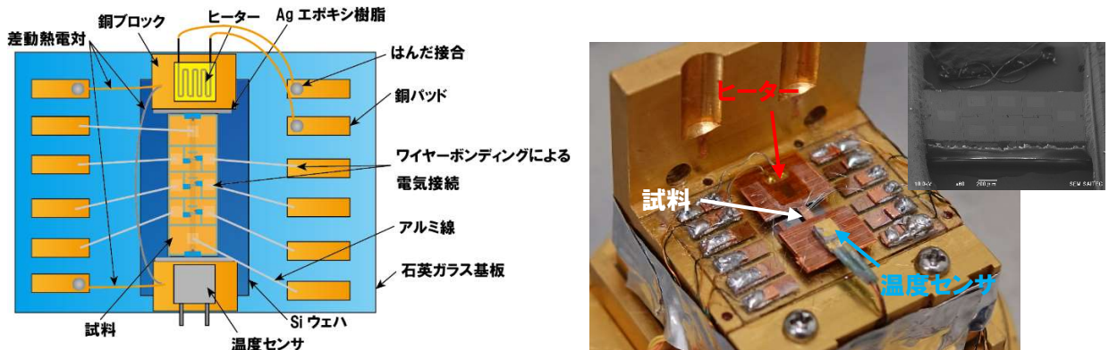
図 4.10 ナノ加工した試料のセットアップ図
