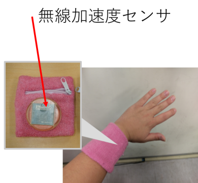
図 3.2: リストバンド型加速度センサ
