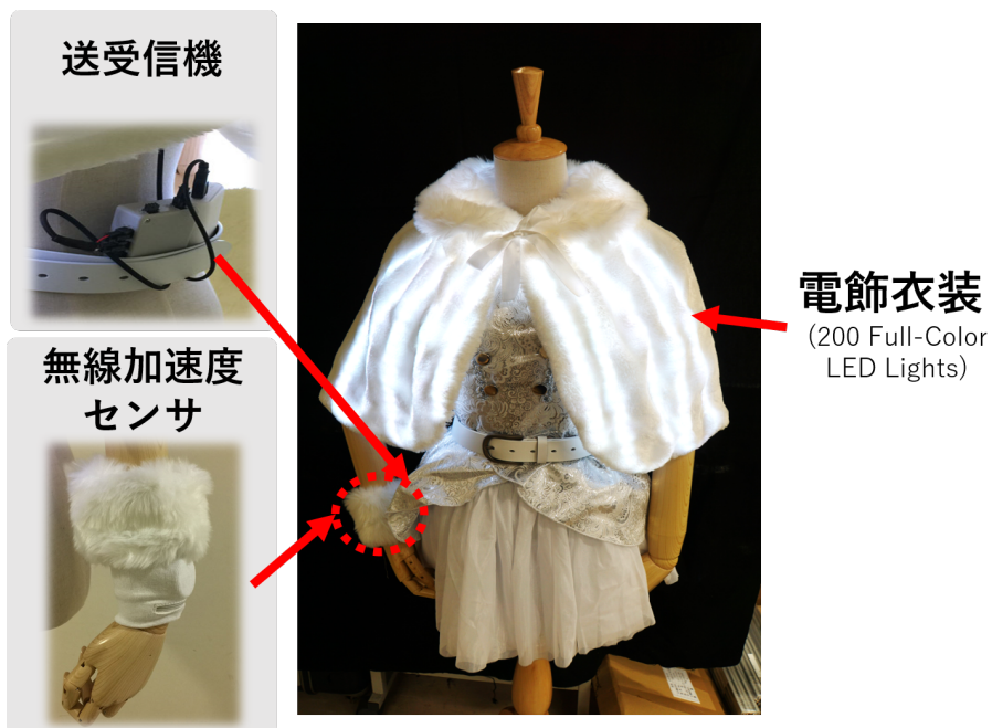
図 3.22: 本実験にあわせて製作した電飾衣装
