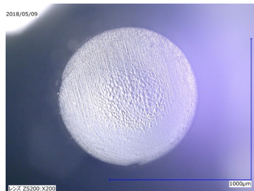
図 5-22 研磨後のサンプル端面（光学顕微鏡観察画像） [研磨条件：Base= 400 rpm, Head: 150 rpm, 1800 s, コンポールサイズ 50 滴下量少なめ]
