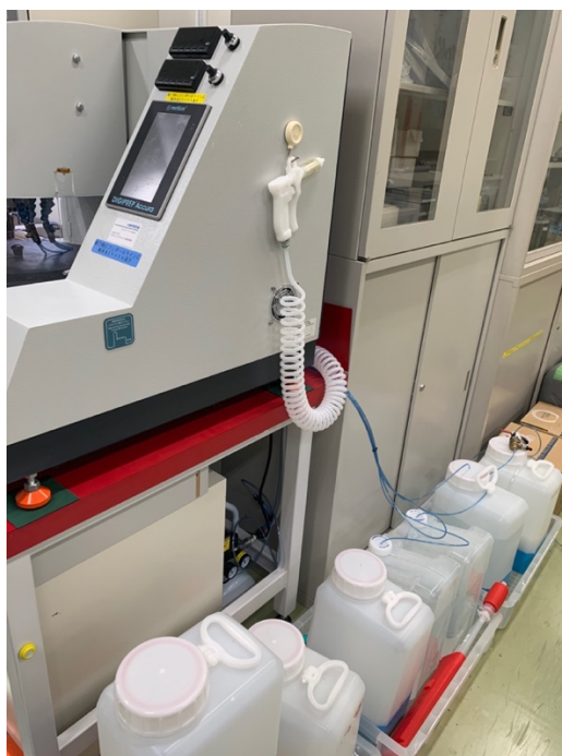
図 5-13 自動研磨装置への純水およびコンポール液供給タンク
