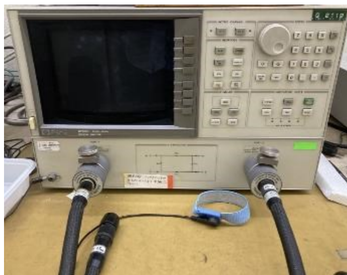
図 2.7.1 ネットワークアナライザ(keysight 8722C)
