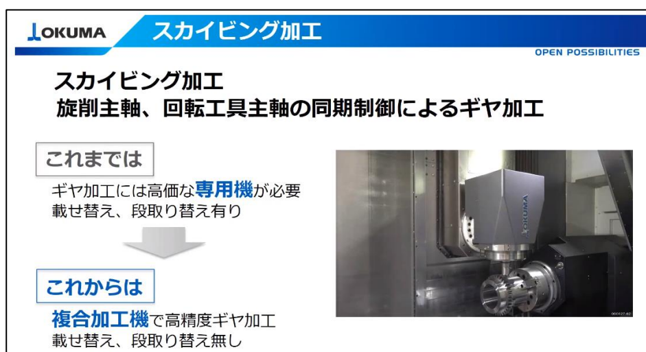
スカイピング加工機との複合化による工程集約
