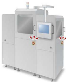
メンテナンス時間を長引かせずスイッチ交換 半導体装置の緊急停止装置破損による損害回避のための複数設置
