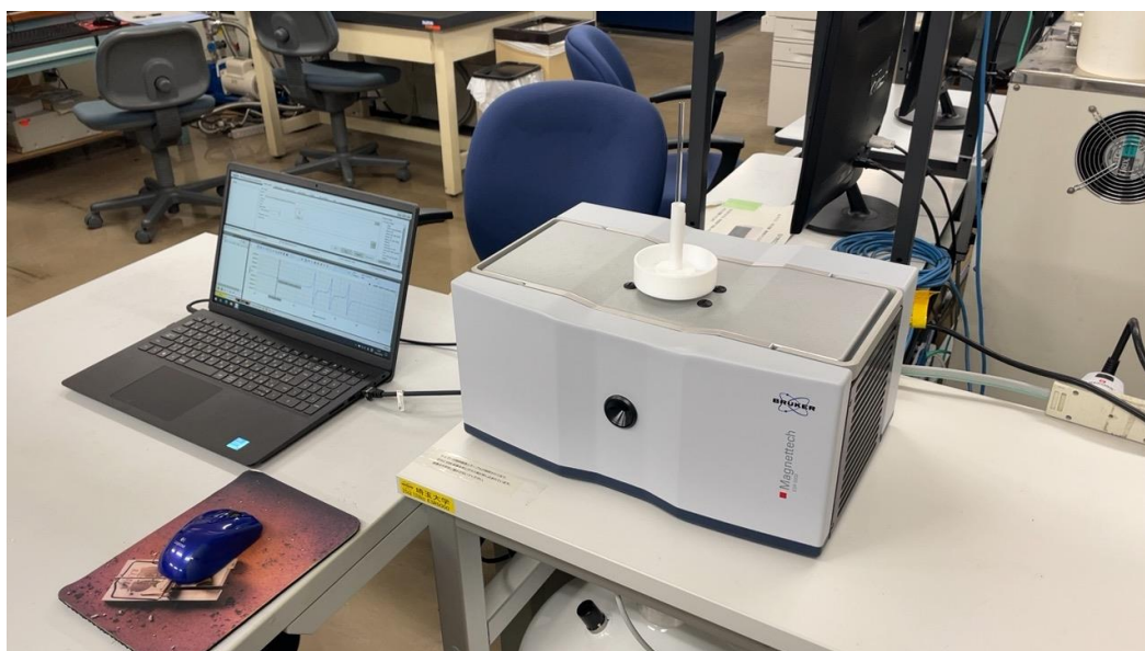
電子スピン共鳴装置 Magnetech ESR5000 (左が制御 PC, 中央が装置本体, 本体下が低温実験用の液体窒素ジュワー)
