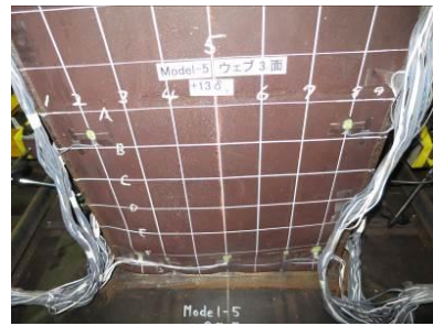
(c) 実験終了時 (+13 \delta_{sy} ) ウェブ変形写真
