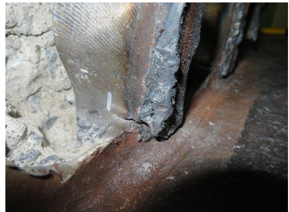
写真 4-9-20 Model-6 供試体 縦リブき裂状況
