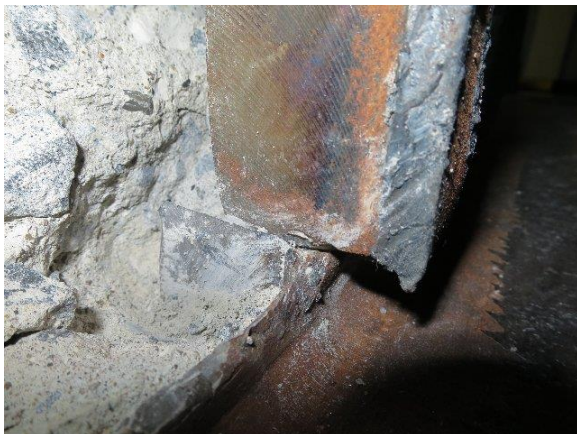
写真 4-9-19 Model-6 供試体 縦リブき裂状況
