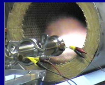
図5: 爆ごう波を利用したエンジン(PDE)
