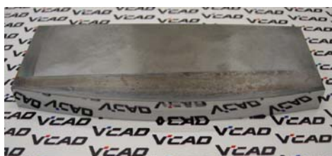
図 4 加工した f-θ 金型例
