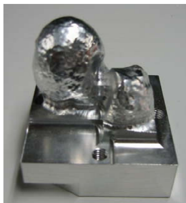
図 7 4 軸 V-CAM による人工股関節骨頭の加工結果
