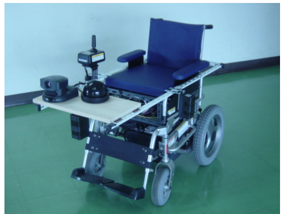
図 3. 知的車椅子：距離センサとして光電センサ 4 台使用.
