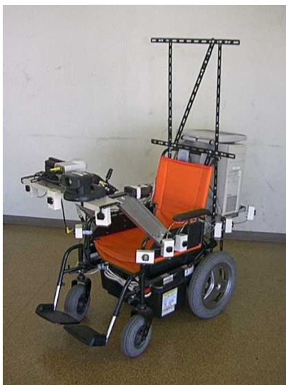
図 2. 知的車椅子：距離センサとして 16 個の超音波センサ使用.
