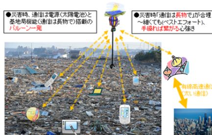
図7 災害時の通信チャネル確保
