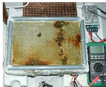
写真-1 電食後のRC供試体
